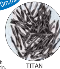
Material:TITAN V=75m/min. f=0.18mm/tooth S=1500r/min F=1700mm/min.
