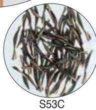
Material:S53C V=500m/min. f=0.25mm/tooth S=10000r/min F=10000mm/min.
