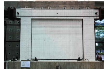
圖 4-13 AS 試體層間變位 1% pull (3 rd )之照片
