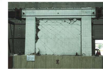
圖 4-19 A14 試體層間變位 3% 實驗結束之照片
